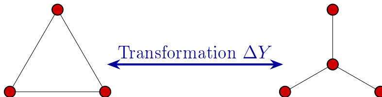
FIGURE 7.18 : La transformation \Delta Y .
